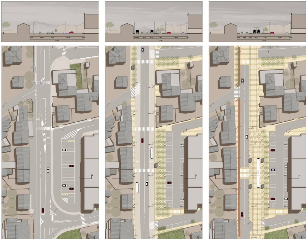
La via Emilia a Diegaro di Cesena: stato attuale (a sinistra), ipotesi di inserimento di corsie preferenziali per l'autobus (al centro) e di una linea di tram (a destra). (Progetto di Valter Balducci, Valentina Orioli, Enrico Brighi, 2008)
